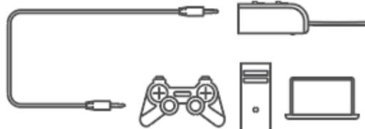
**Câble de 3,5 mm** : Branchez-le sur une prise de 3,5 mm d'une manette de jeu ou du port audio d'un ordinateur (de bureau ou portable). Lors de l'utilisation de ce câble, les effets d'éclairage à prisme ne sont pas disponibles.
